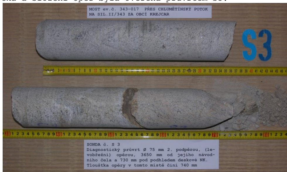
Obr.G34-100 SONDA S3. Diagnostický průvrt Ø 75 mm 2. podpěrou, (levobřežní) opěrou, 3650 mm od jejího návodního čela a 730 mm pod podhledem deskové NK. Tloušťka opěry v tomto místě činí 740 mm.
