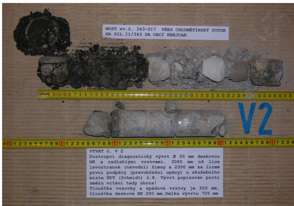
Obr. G34-103 Vývrt č.V2. Dostrovní diagnostický průvrt Ø 50 mm deskovou NK a nadlehlými vrstvami, 3060 mm od líce levostranné (návodní) římsy a 2350 mm za lícem první podpěry (pravobřežní opěry) u zkušebního místa NDT (Schmidt) č.8. Vývrt popisován proti směru vrtání tedy shora! Tloušťka vozovky a spádové vrstvy je 505 mm, tloušťka deskové NK 200 mm. Délka vývrtu 705 mm. Pevnost betonu v tlaku stanovená z části vývrtu V2-4, z hloubky vývrtu 505 ÷ 705 mm.
