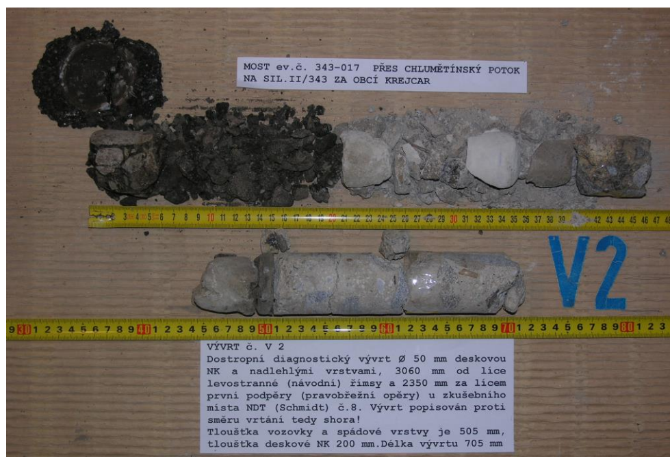
Obr.G34-101 Vývrt č.V2. Dostrovní diagnostický vývrt Ø 50 mm deskovou NK a nadlehlými vrstvami, 3060 mm od líce levostranné (návodní) římsy a 2350 mm za lícem první podpěry (pravobřežní opěry) u zkušebního místa NDT (Schmidt) č.8. Vývrt popisován proti směru vrtání tedy shora! Tloušťka vozovky a spádové vrstvy je 505 mm, tloušťka deskové NK 200 mm. Délka vývrtu 705 mm.
